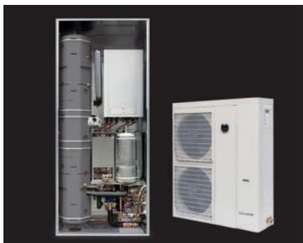
Sistema a pompa di calore e caldaia di integrazione per impianti di riscaldamento/raffrescamento ambiente e produzione A.C.S. con accumulo di ben 150 l, configuratore di sistema per ottimizzare i consumi tramite l'accensione del generatore più efficiente.
