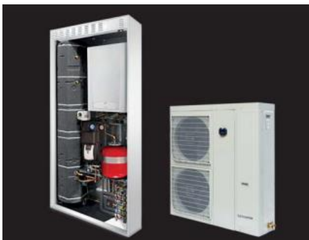
Sistema solare a pompa di calore e caldaia di integrazione per impianti di riscaldamento/raffrescamento ambiente e produzione A.C.S. con accumulo di ben 150 l, centralina di gestione solare e configuratore di sistema per ottimizzare i consumi tramite l'accensione del generatore più efficiente.
