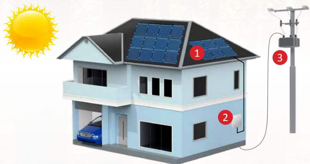
**1.** I pannelli fotovoltaici, costituiti da celle fotovoltaiche, catturano la luce del sole e la convertono in energia pulita, in una forma che si definisce "corrente continua". Questo processo funziona anche nei giorni nuvolosi perché per produrre energia fotovoltaica non è necessaria la luce diretta del sole.
